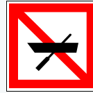
A.16 SFVO · WVO Verbot für Fahrzeuge, die weder mit Maschinenantrieb noch unter Segel fahren
